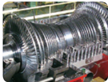
蒸気タービン
