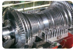
蒸気タービン
