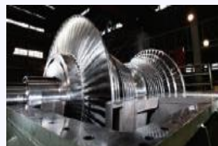
火力発電設備 蒸気タービン・発電機
