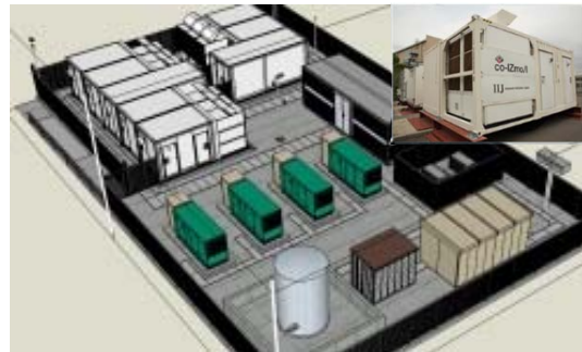
コンテナ型IDC (高圧受電+自家発電設備)
