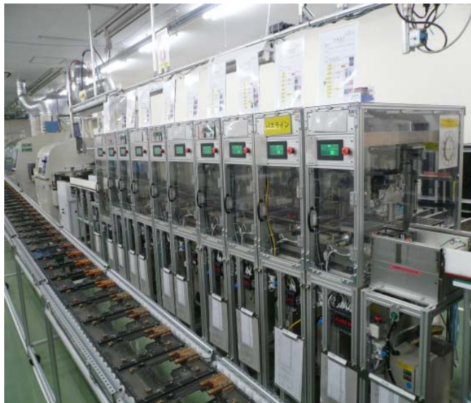
スマートメータ自動化・組立ライン
