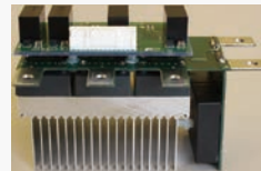
電力密度：81kW/L (出力：37kW、容量：0.46L)
