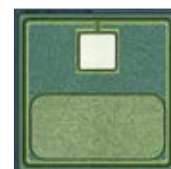
トレンチゲート構造を採用した SiC-MOSFET
