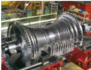
蒸気タービン
