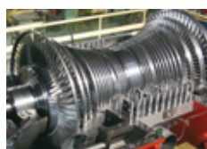
蒸気タービン
