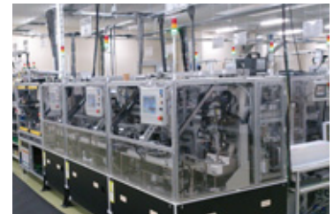
自動化したインバータの組立ライン(鈴鹿工場)
