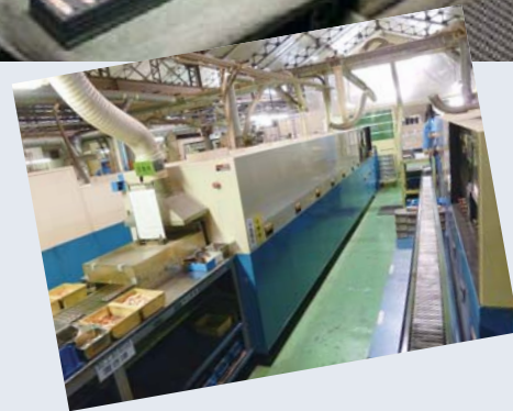
部品はカーボン製のトレイに並べられ(写真上)、高温の炉で溶接される(写真下)
