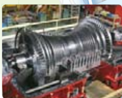
蒸気タービン
