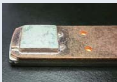
溶接で銀が十分に溶けて二つの部品がしっかり固定された状態。 現場の取り組みで良品率が向上した
