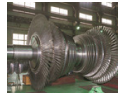
地熱発電用タービン
