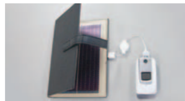
フィルム型アモルファス太陽電池を貼り付けたブックカバーで場所と時を選ばずに携帯電話を充電します(共同開発を進めている独立行政法人産業技術総合研究所様の試作品)
