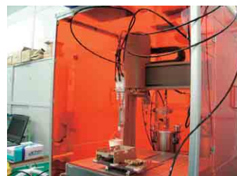
DCMの使用を全廃した接着剤塗布機
