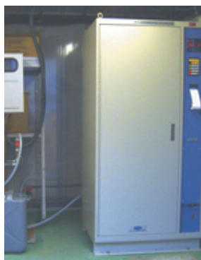
指定閉鎖性海域に排水する富士電機システムズ・川崎事業所ではリン・窒素測定装置を導入
