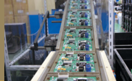
はんだ付けが終わり、フローはんだ機から出てくる基板
