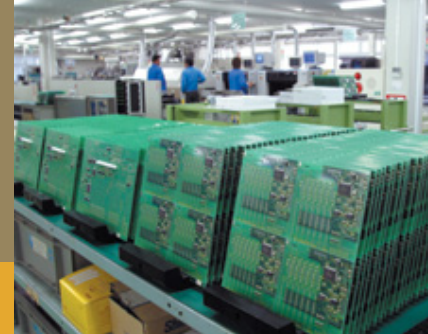
電子機器基板に含まれる鉛は、FIC製品に含まれる有害物質の80%を占める。
