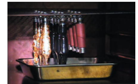
350~400℃で流動化するPA、PPSは導体金属と分離しやすいため、樹脂の回収、マテリアルリサイクルが可能
